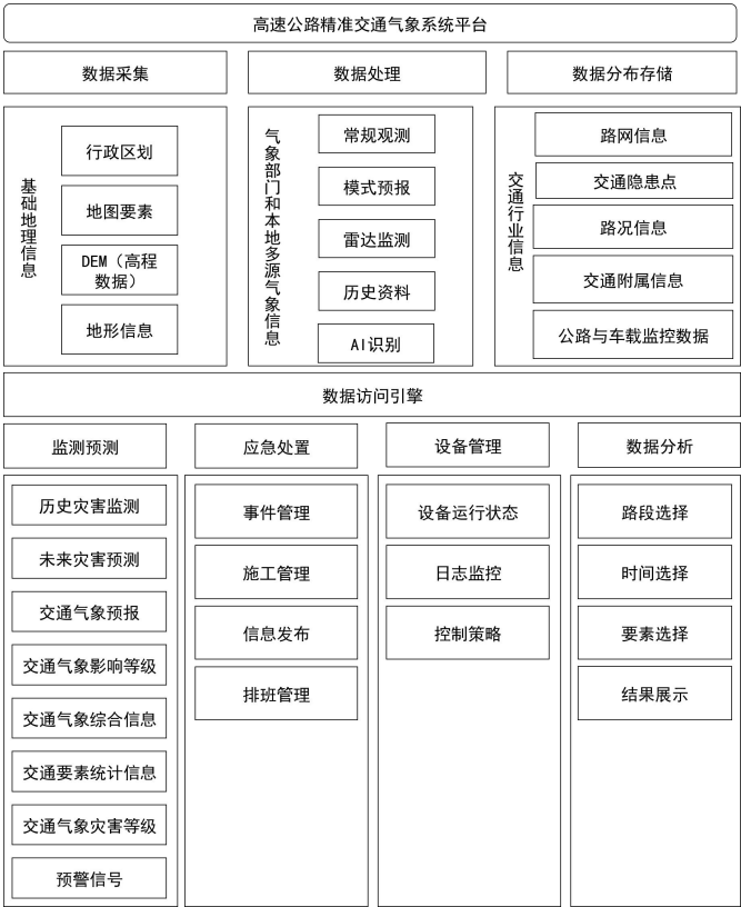
图1 高速公路交通气象系统功能框架图
